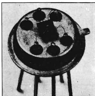
Fig. 7 - Così si presenta internamente il montaggio elettronico del transistor duale BCY87.
